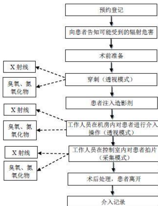
图 2-2 医用血管造影 X 射线机工作流程及产污环节
